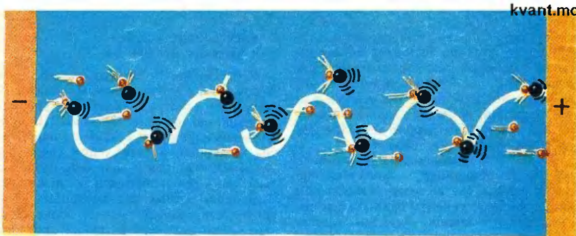
Рис. 4. Нарушение правильности атомного волновода тепловым движением.
